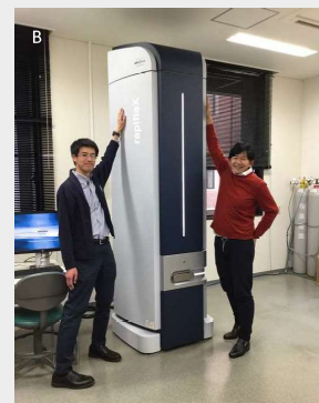
同志社大学生命医科学部医生命機能研究室に配備されたイメージング質量分析計 A. IMScope (島津製作所) B. Rapiflex tissue typer (Bruker Daltonics)
